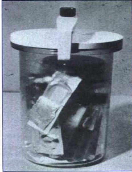
شکل 1: سیستم گازیک جهت کشت باکتری‌های بی‌هوازی
