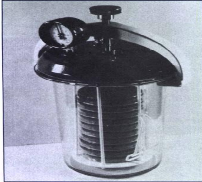
شکل 1: جار بی‌هوازی Oxoid جهت کشت باکتری‌های بی‌هوازی
